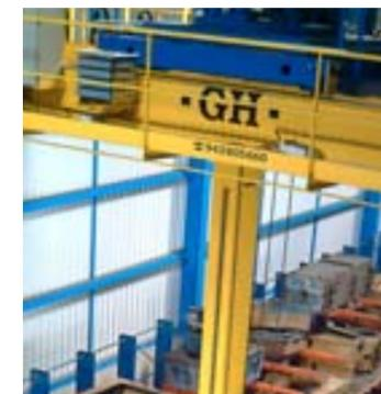
Otra de las grúas hecha a medida de las necesidades del cliente y recientemente fabricada por GH es la Grúa con Mástil Giratorio de 10 tn. y 11,45 m. de luz realizada por encargo de la empresa gipuzcoana TS FUNDICIONES para el almacenamiento de moldes de fundición.
