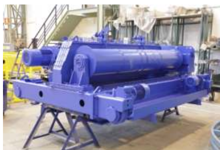
7E - Seguridad redundante, reducciones planetarias doble tambor freno de seguridad tambor
