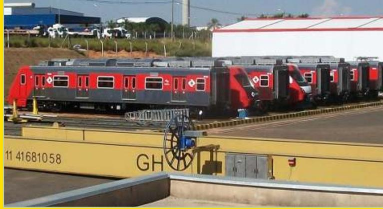
GH fabrica también transbordadores ferroviarios, para capacidades entre 60 t. y 150 t., utilizados sobretodo en el manejo de trenes en las labores de mantenimiento. De ellos destaca la rapidez, seguridad y la facilidad de desplazamiento.
